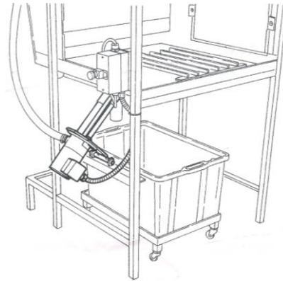
Vérifier périodiquement, selon la fréquence d'utilisation et le genre d'émail employé, l'état de propreté du tube métallique perforé A permettant l'écoulement d'eau sur le rideau.
