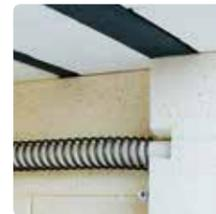
Keramische Rohre zur gleichmäßigen Einbringung der Spülluft
