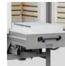
Elektrisch ausfahrbarer Ofenboden
