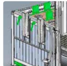
Automatische Zu- und Abluftklappen
