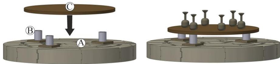
Fig.41 : Déposer la plaque de montage (C) sur les supports de montage (figure similaire)
