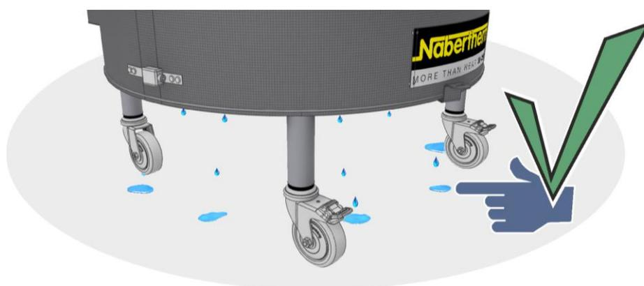
Fig. 29: Accumulation de condensat pendant les premières cuissons (figure similaire)
