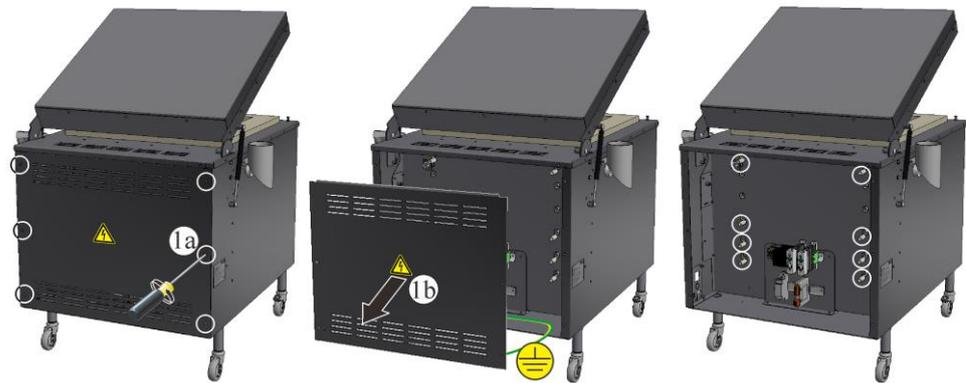
Fig. 75: Démontez le couvercle de l'unité de commande au dos du four (figure analogue)
