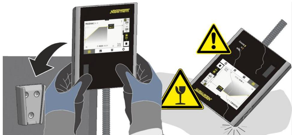
Fig. 33: Mettre le programmeur en place sur le support fixé sur le four (figure analogue)
