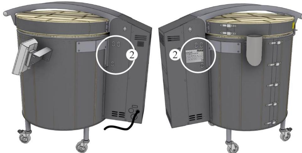
Vis situées de part et d'autre du couvercle de l'armoire de distribution pour le réglage du couvercle
