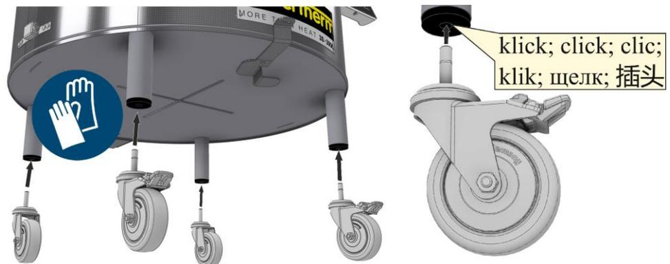
Fig. 15: Montage des roulettes de transport (figure similaire)
