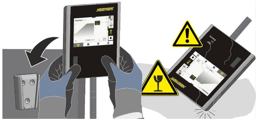
Fig. 21: Mettre le programmeur en place sur le support fixé sur le four (figure analogue)
