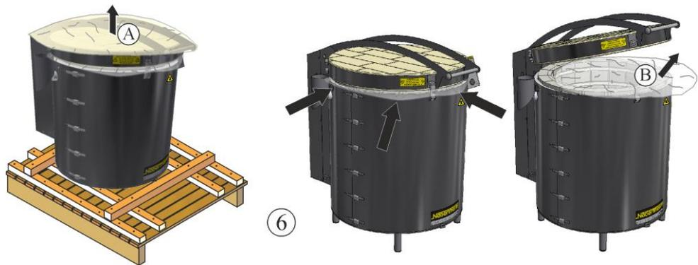
8. Saisir le four par le dessous pour le porter latéralement (au niveau des pieds) et veiller à bien le maintenir. **Porter des gants de protection pour mettre le four en place !** Soulever le four de la palette en gardant le dos droit et le déposer avec précaution sur son lieu d'implantation. Il faut au moins 2 personnes ou plus pour exécuter les travaux de transport.
