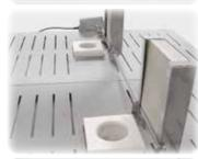
Trappe d'évacuation d'air motorisée pour un refroidissement accéléré du four après achèvement de la cuisson.
