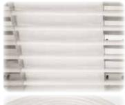
Éléments chauffants en disposition serrée dans la voûte, protégés par des tubes en verre de quartz, permettant un rayonnement direct et uniforme sur le verre
