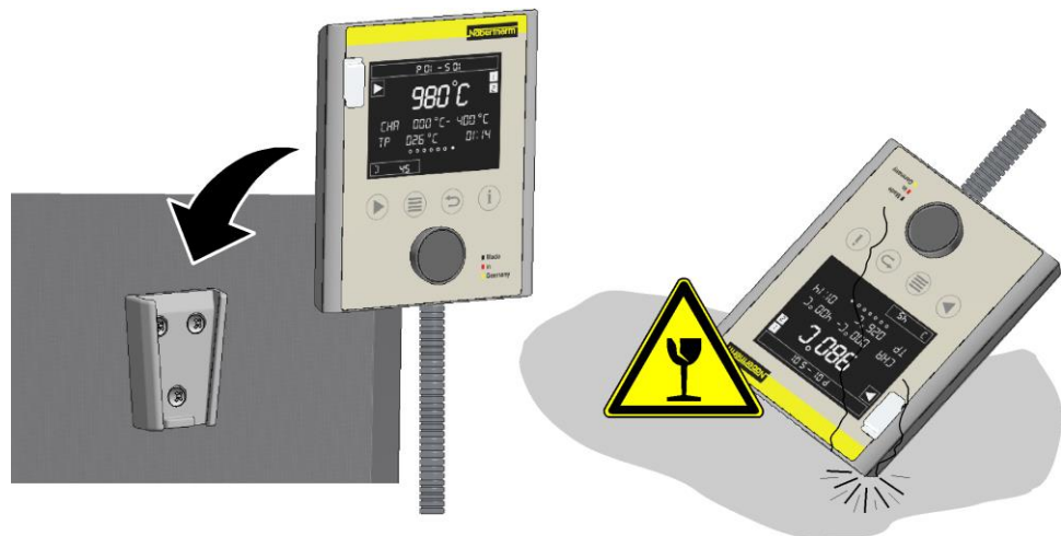
Fig. 18: Mettre le programmeur en place sur le support fixé sur le four (figure analogue)
