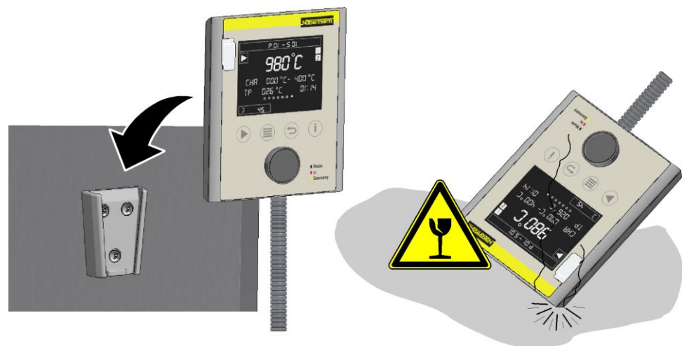
Fig. 27: Mettre le programmeur en place sur le support fixé sur le four (figure analogue)
