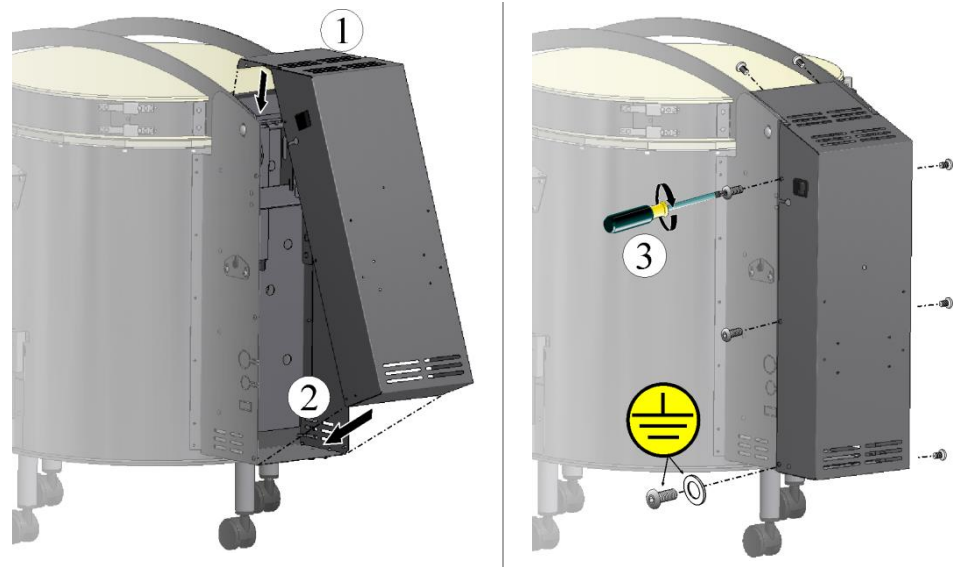
Fig. 54: Montage du couvercle de l'unité de commande (figure analogue)
