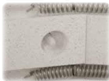
Thermocouple protégé, monté dans l'isolation
