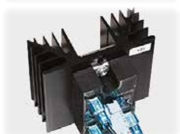
Commutation silencieuse du chauffage par relais semi-conducteurs
