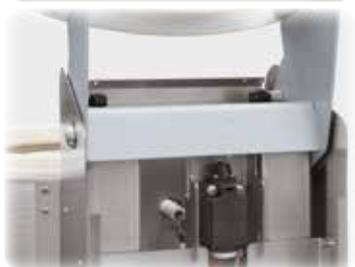
Contacteur de sécurité à coupure forcée dans le couvercle.
