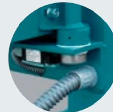
Interrupteur de sécurité, monté de façon protégée
