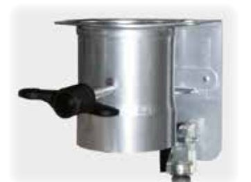
Trappe d'entrée d'air semi-automatique pour le séchage résiduel pour fours chambre jusqu'à 300 litres. La trappe se ferme automatiquement à une température déterminée et n'a pas besoin d'être fermée manuellement après une phase de séchage.
