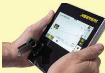
Enregistrement des données du processus du régulateur connecté via clé USB
