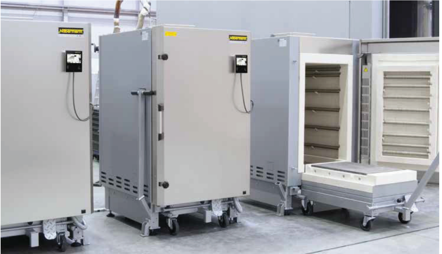
Fours à chambre avec chariot extractible pour un chargement ergonomique de la chambre de cuisson
