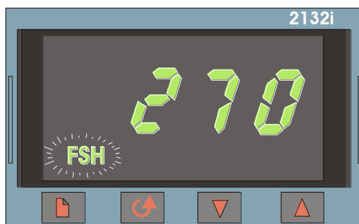
Fig. 63 : Régulateur de sécurité de surchauffe 2132i
