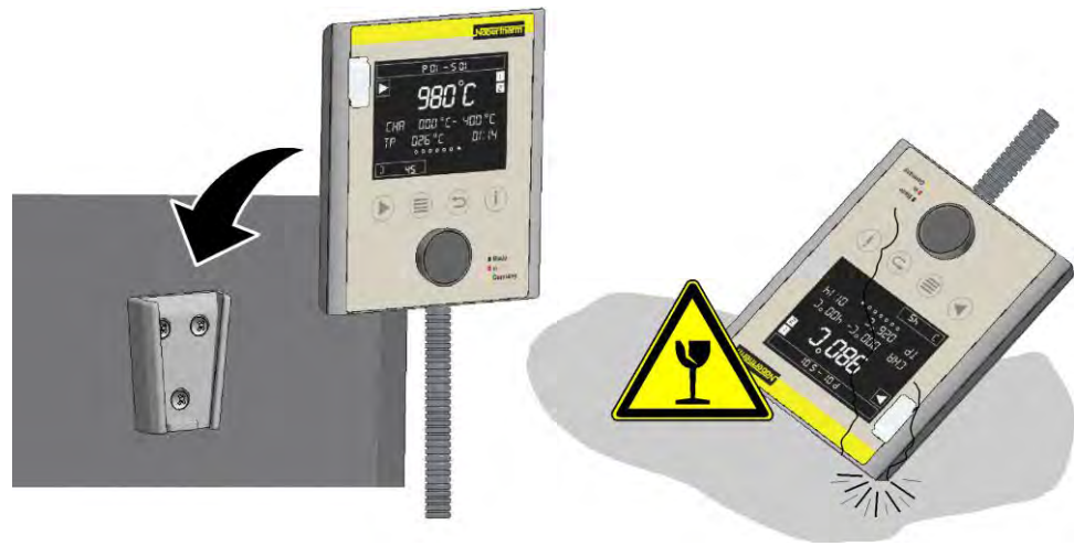
Fig. 62: Mettre le programmeur en place sur le support fixé sur le four (figure analogue)
