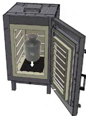
Fig. 55: Recommandation : sollicitation maximale de la sole du four (figure analogue)
