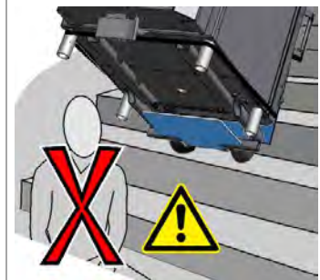
Fig. 19: Transport sécurisé d'un four avec un monte-escalier (figure analogue)
