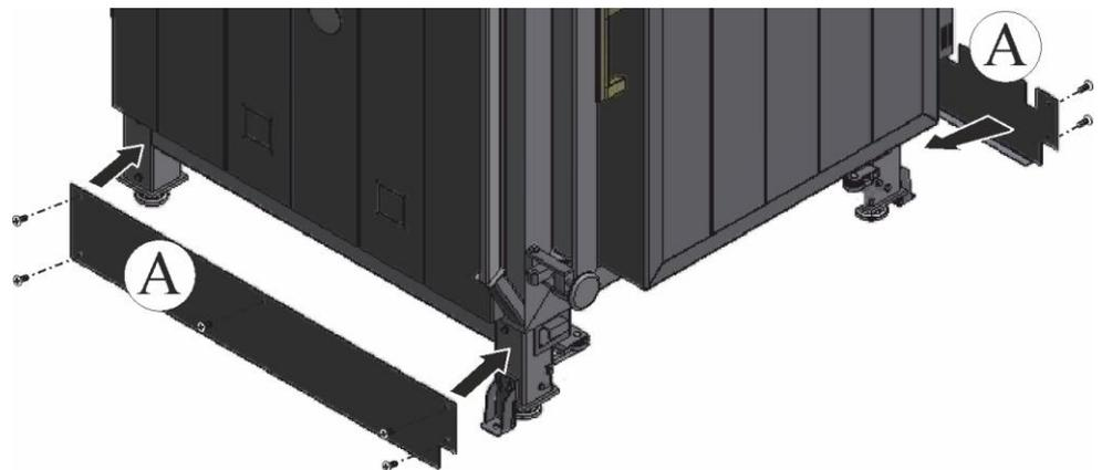
Fig. 46: Montage des tôles latérales (figure analogue)
