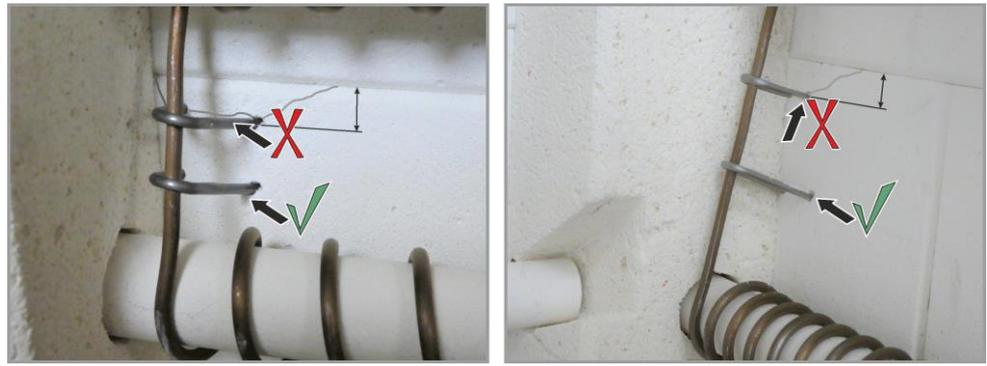
Fig. 102 : Installation incorrecte et correcte des crampons (figure similaire)
