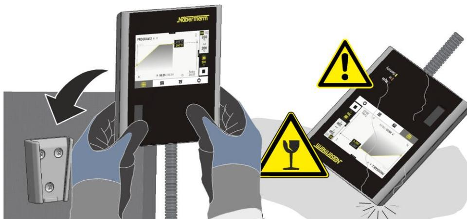
Fig. 71: Mettre le programmeur en place sur le support fixé sur le four (figure analogue)
