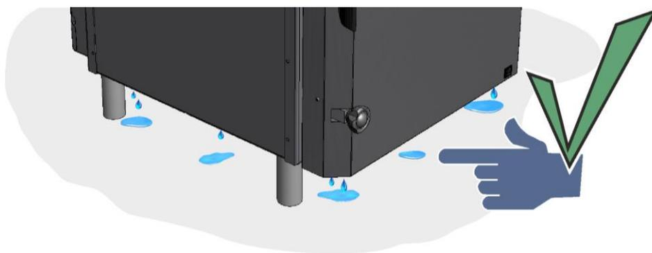
Fig. 67: Accumulation de condensat pendant les premières cuissons (figure similaire)
