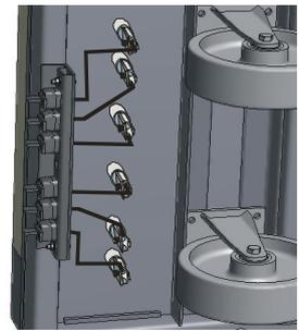
Exemple : bornes pour éléments chauffants dans la chambre de four placé au dos du four
