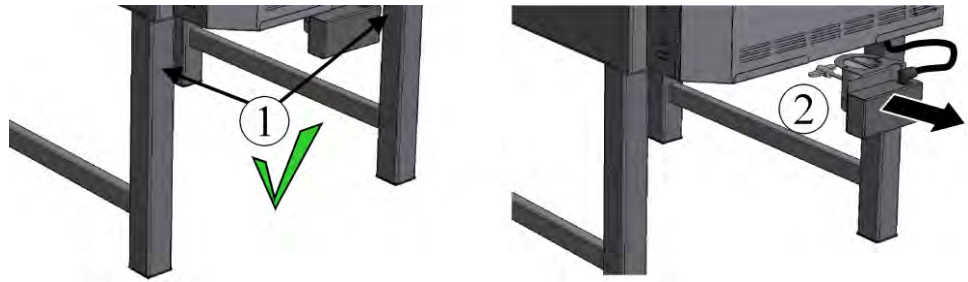
Fig. 39: Retirer la trappe d'entrée d'air du support (figure analogue)
