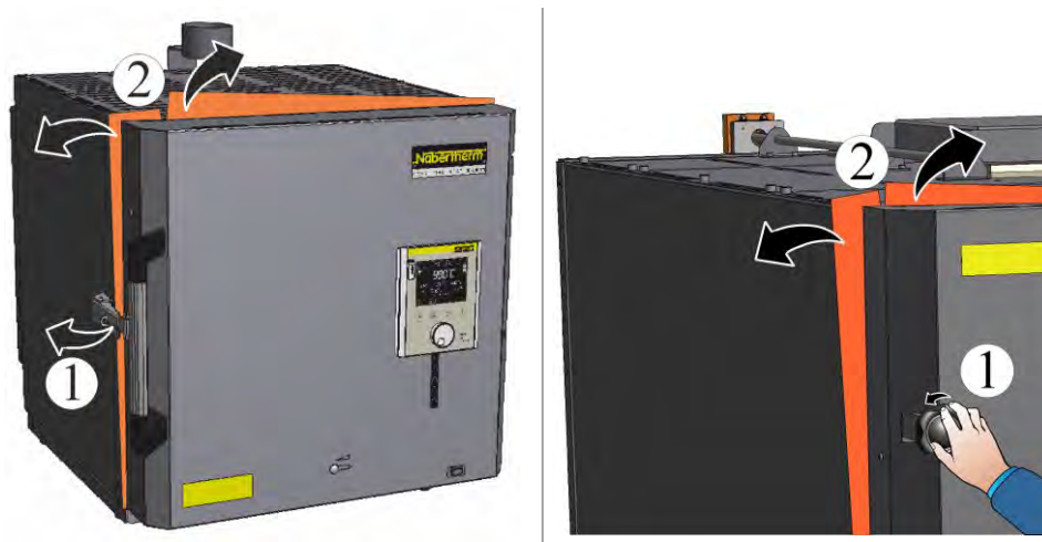
Fig. 12: Exemple : Enlever la protection de transport (figure analogue)
