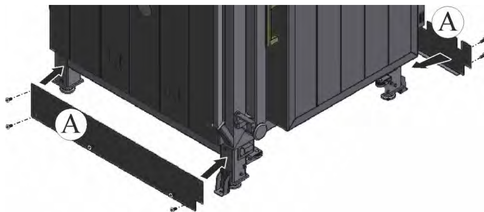
Fig. 37: Montage des tôles latérales (figure analogue)
