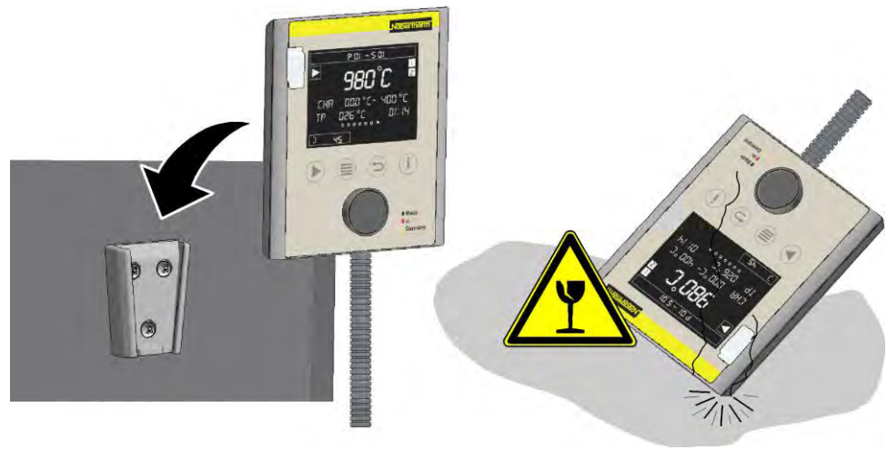
Fig. 62: Mettre le programmeur en place sur le support fixé sur le four (figure analogue)
