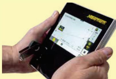
Enregistrement des données du processus du régulateur connecté via clé USB
