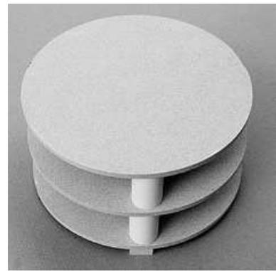
Platzieren Sie die mitgelieferten Cordierit-Klötzchen (Bild links) auf den Boden des Brennofens, dann legen Sie eine erste Besatzplatte (optionales Zubehör) darauf (Bild mitte). Beachten Sie, dass alle Besatzplatten und Stützen eingebrannt werden müssen (siehe Punkt 3.6)! Eine zu nahe an die Heizwendeln gesetzte Platte ist stark rissgefährdet. Es sollten mindestens 20 mm Abstand zur Spirale eingehalten werden.
