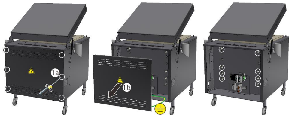
Fig. 58: Démontez le couvercle de l'unité de commande au dos du four (figure analogue)
