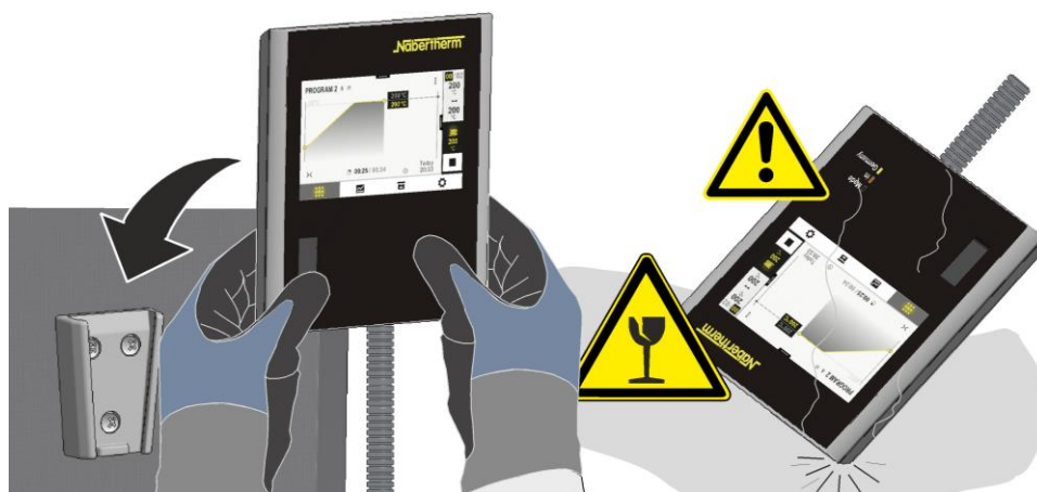
Fig. 30: Mettre le programmeur en place sur le support fixé sur le four (figure analogue)
