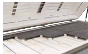
Chauffage de la sole assurant un échauffement homogène d'objets de grande taille en option.
