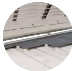
Chauffage de la sole assurant un échauffement homogène d'objets de grande taille.
