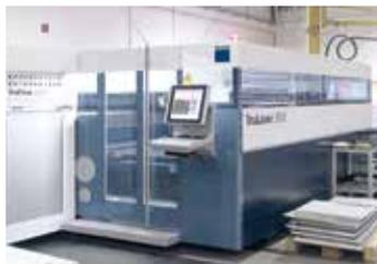
Nous utilisons les machines les plus en pointe pour que nos fours puissent à l'avenir aussi être produits sur notre site allemand. Toutes les pièces en tôle sont p. ex. coupées sur une machine à découper au laser.
