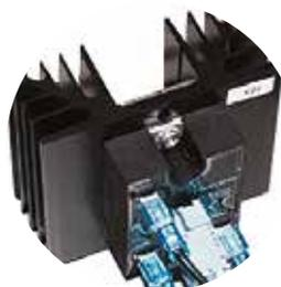
La puissance est transmise par des relais statiques. Ils sont silencieux, pratiquement inusables et battent en cadence rapide pour permettre de s'adapter idéalement à la courbe de cuisson demandée.
