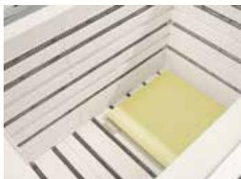
Chambre du four à chargement vertical avec chauffage sur 5 côtés
