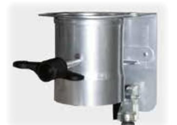
Trappe d'entrée d'air semi-automatique pour le séchage résiduel pour fours chambre jusqu'à 300 litres. La trappe se ferme automatiquement à une température déterminée et n'a pas besoin d'être fermée manuellement après une phase de séchage.
