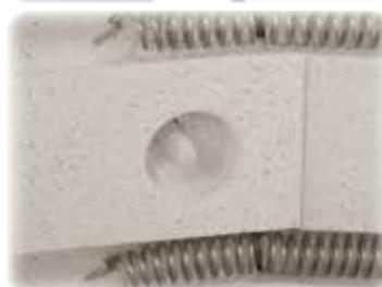
Thermocouple protégé, monté dans l'isolation
