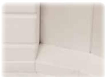
Isolation deux couches en briques légères réfractaires longue durée, avec isolation arrière économe en énergie harmonisée avec la température maximale du four à partir de 80 litres
