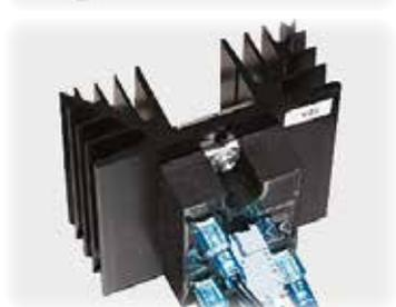
Commutation silencieuse du chauffage par relais semi-conducteurs
