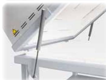
Amortisseurs hydrauliques à gaz facilitant l'ouverture et la fermeture de la cloche
