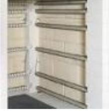
Eléments chauffants boudinées sur tubes porteurs en céramique. Le rayonnement est optimisé, et l'homogénéité de température est excellente. (N 500 E, N 100 - N 2200/H, NW 150 - NW 1000/H)
