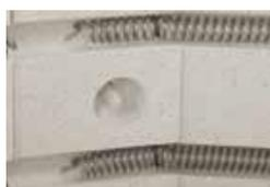
Thermocouple protégé, installé dans l'isolation
