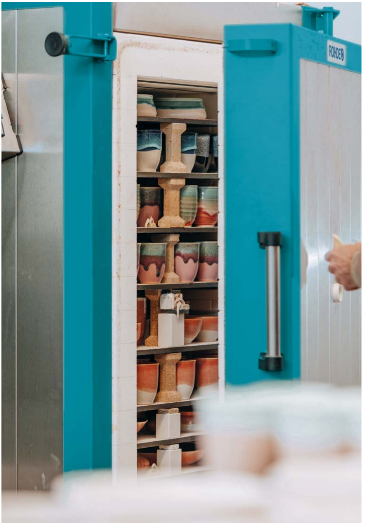
Un four frontal de la série KE-N – chambre de cuisson de 480 litres chauffée à l'électricité photovoltaïque.
