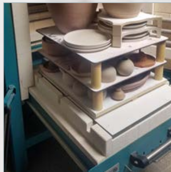
Fours frontaux à chauffage électrique
