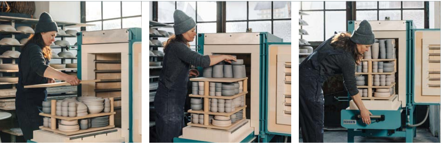
La sole mobile de ROHDE permet un chargement nettement plus rapide, plus sûr et plus compact.
