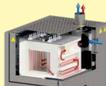
Schéma du flux d'air dans le four combiné LHT 08/17 BO
