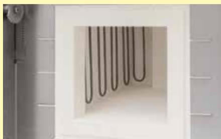
Chauffage haute température dans la chambre du four
