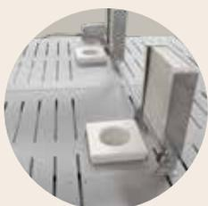
Ouverture d'évacuation d'air manuelle et motorisée dans le toit pour un refroidissement plus rapide. Levier de commande situé sur le côté droit du four (au-dessus de l'armoire électrique).
