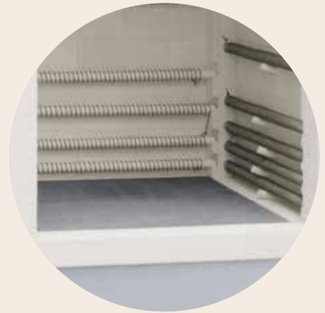
Plaque de fond en SIC pour protéger le chauffage de la sole et permettre un empilage sûr avec bloc de pièce de cuisson
