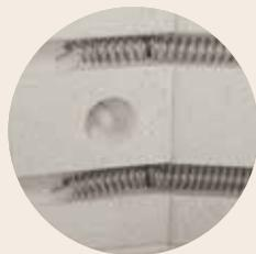
Thermocouple de type S protégé dans l'isolation
