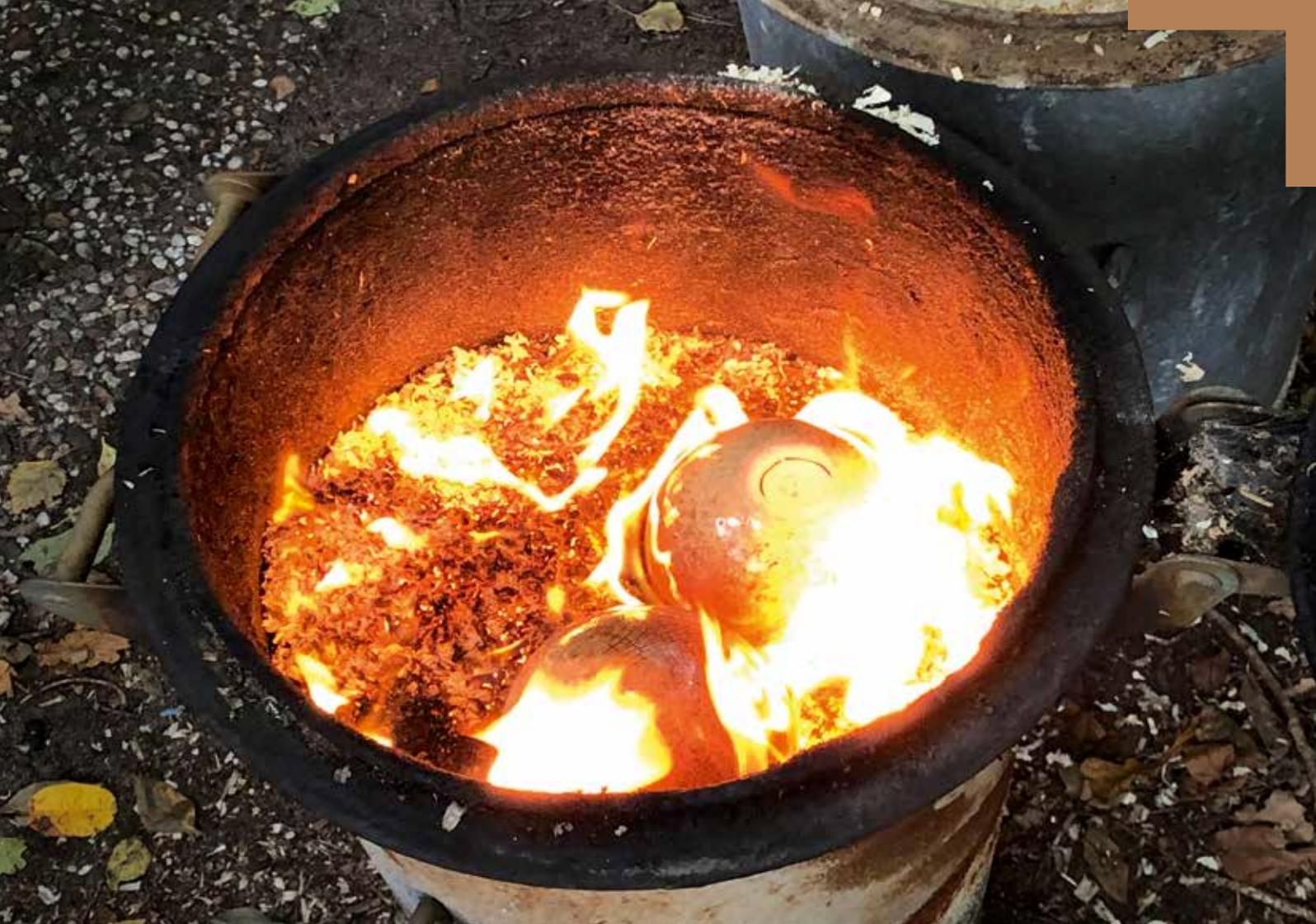
Refroidissement et immersion des objets cuits dans des feuilles mortes, de la paille ou des copeaux
