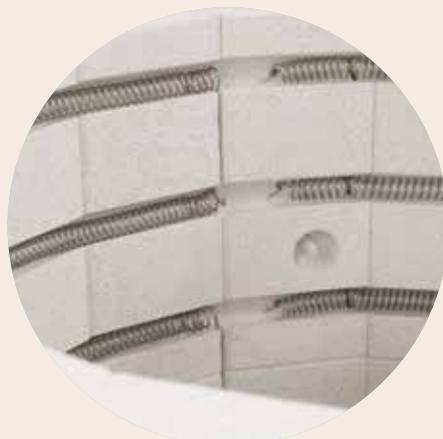
Des éléments chauffants robustes, d'une puissance connectée accrue, pour des montées en température plus rapides
