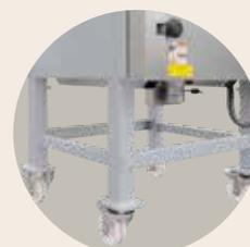
Châssis de chargement facilitant le chargement et déchargement ergonomique devant le four
