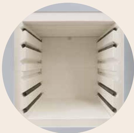
Chauffage sur deux côtés par des éléments chauffants logés dans des rainures protectrices
