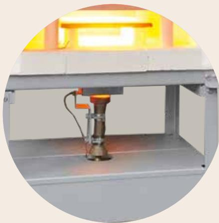
Brûleur au propane de 15 kW, monté sous le four
