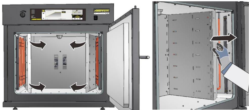
Fig. 47 : Prélever les parois latérales du four (figure similaire)
