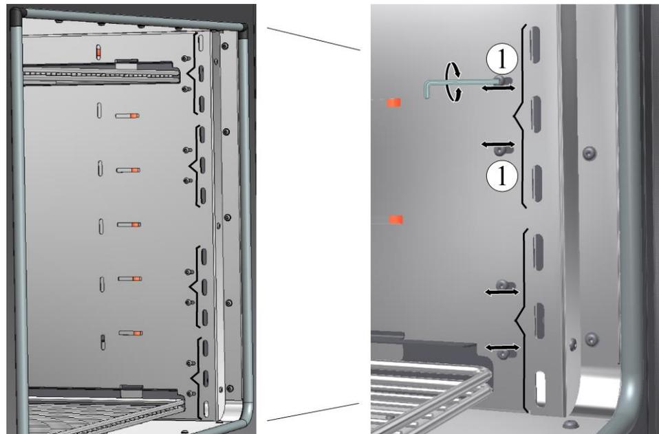
Pour déplacer les plaques de ventilation, desserrer les vis (1)
