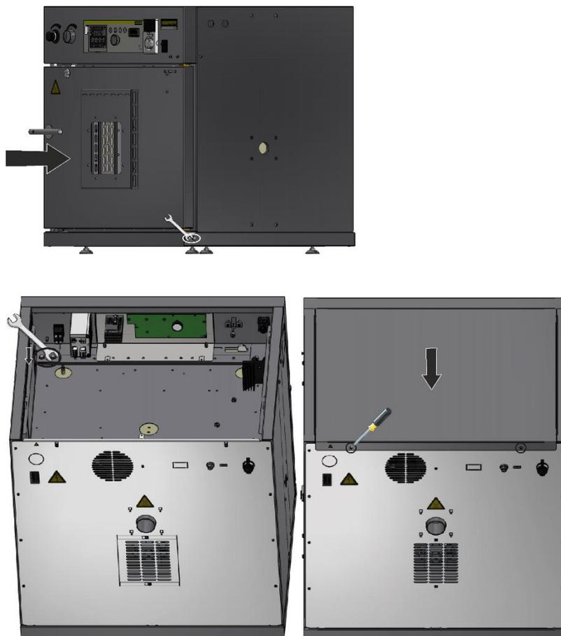
Fig. 73: Installer la porte du four et monter le couvercle du caisson (figure similaire)
