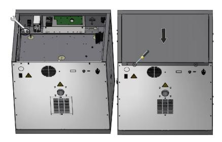
Fig. 73: Installer la porte du four et monter le couvercle du caisson (figure similaire)
