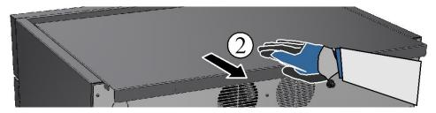
Fig. 43: Démontage du couvercle (figure analogue)
