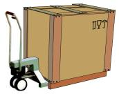
Fig. 10 : Le chariot élévateur est **entièrement** enfoncé sous le châssis de transport (figure analogue)
