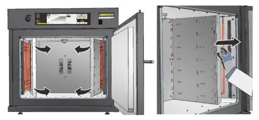
Fig. 47 : Prélever les parois latérales du four (figure similaire)
