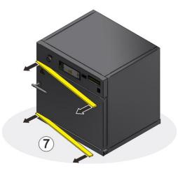
6. Pour porter l'étuve, prenez celle-ci par le bas des côtés (au niveau des pieds) et veillez à un maintien sûr. Soulevez l'étuve de la palette en tenant le dos droit et déposez-la avec précaution sur le site d'installation. Le dispositif de blocage
