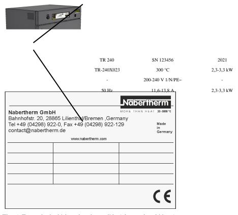
Fig. 6: Exemple de désignation du modèle (plaque signalétique)
