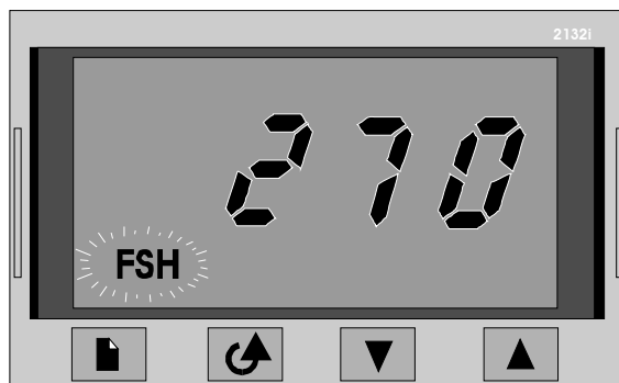
Fig. 27 : Le régulateur de sécurité de surchauffe 2132i (figure similaire)
