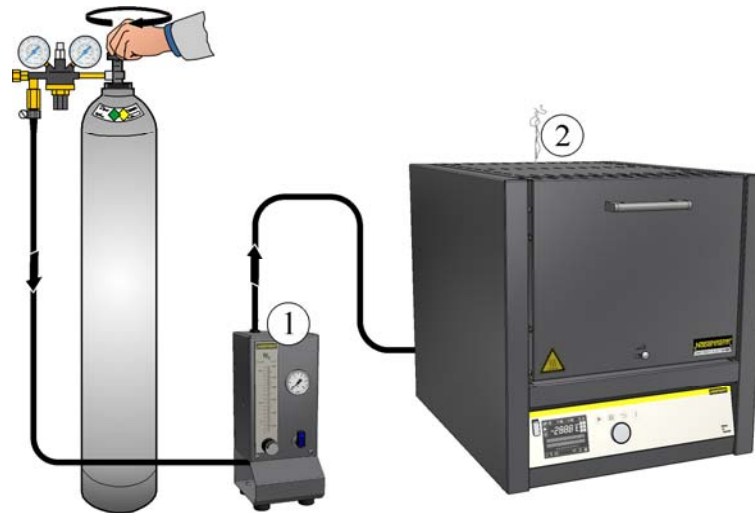
Fig. 44: Raccordement du système de gazage (figure similaire)
