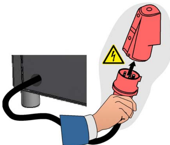
Fig. 22: En fonction du modèle (connecteur CEE) (figure analogue)
