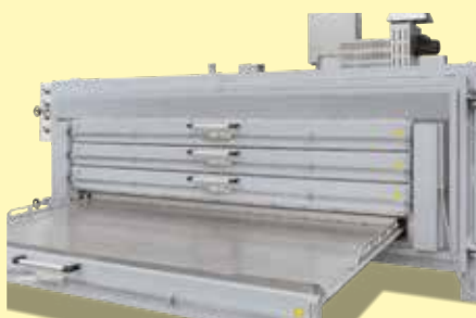
Four à tiroirs NA 6700/26HAS avec 4 tiroirs pour le traitement thermique de pièces plates
