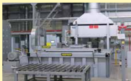
Bac de trempe à l'huile OAB 67000 avec échangeur de chaleur et contenant 67 000 litres d'huile
