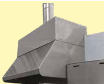
Hotte d'évacuation au-dessus de l'ouverture de chargement
