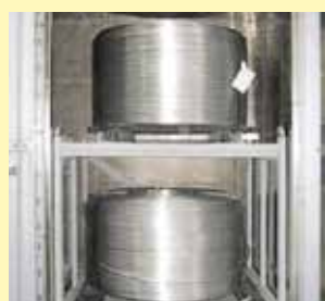
Transfert de chaleur entre charge à l'état chaud et charge à l'état froid
