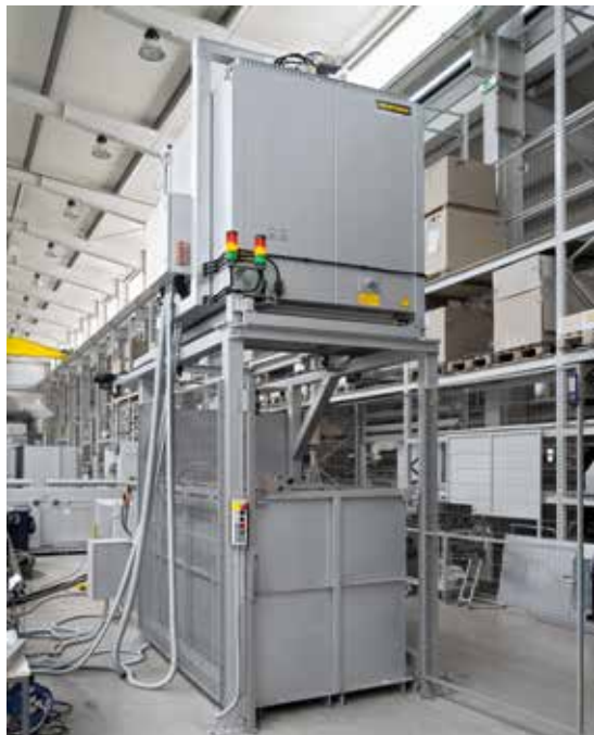
Installation de four vertical avec bac de trempe fixe (variante A)
