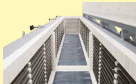
Chambre de four S 5120/GS avec logement de la plaque isolante pour réduire la chambre de moitié
