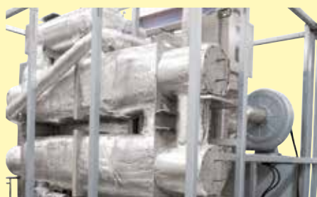
Echangeur thermique à contre-courant sur le four chambres à convection forcée N 2560/26 ACLS
