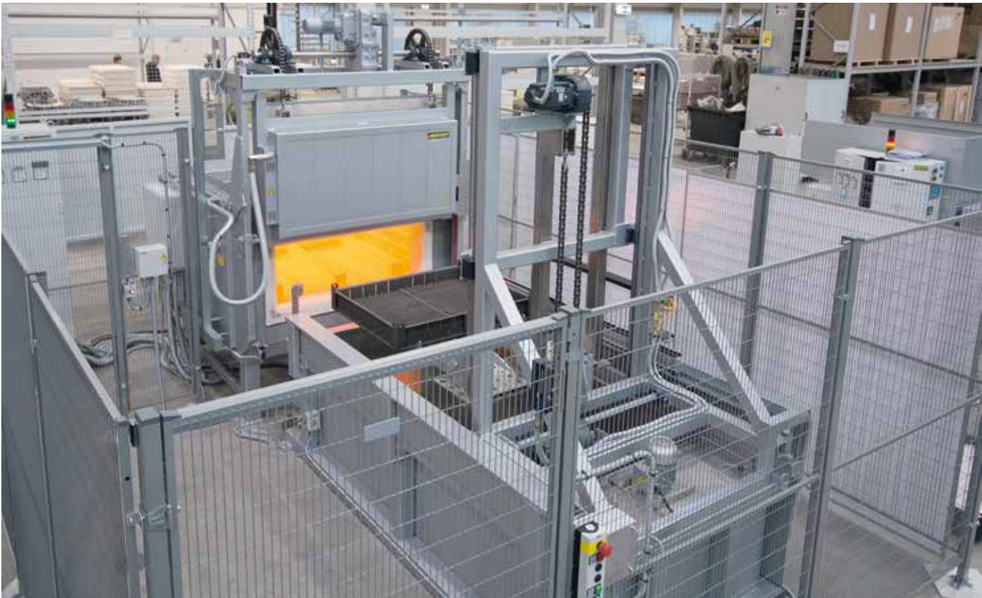
Installation de trempe et de revenu entièrement automatique composée d'un four de recuit, d'un bac de trempe à l'eau et d'un manipulateur à deux axes
