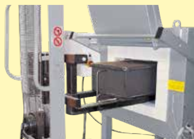
Travail avec caisson d'alimentation en gaz pour atmosphère gazeuse protectrice à l'aide d'une navette de chargement
