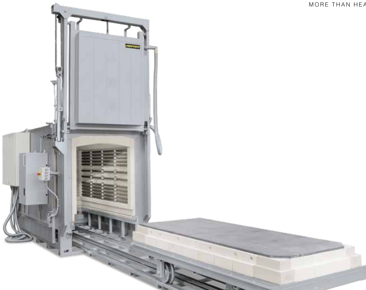
Four à sole mobile WS 2200/10 avec porte guillotine électro-hydraulique et chariot à entraînement électrique
