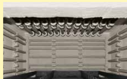
Chambre de four avec chauffage de plafond comme option si le four est utilisé comme four de préchauffage pour les largets de tôles
