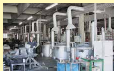
Brûleur à système de récupération sur fours de fusion d'aluminium 16 x TBR 110/12 et 2 x TBR 180/12
