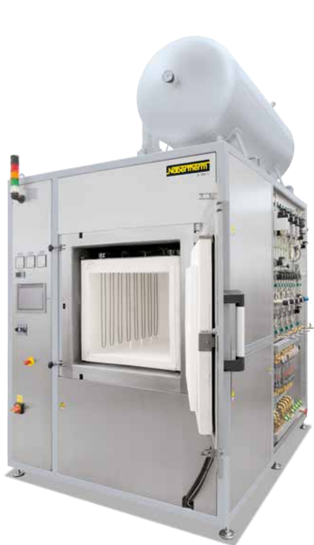
Four moufle étanche VHT 100/15-KE H 2 avec isolation en fibre et réservoir additionnel pour fonctionnement sous hydrogène, 1400 °C
