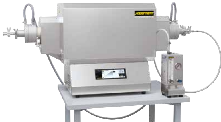
Four tubulaire compact de laboratoire avec système manuel d'alimentation en gaz
