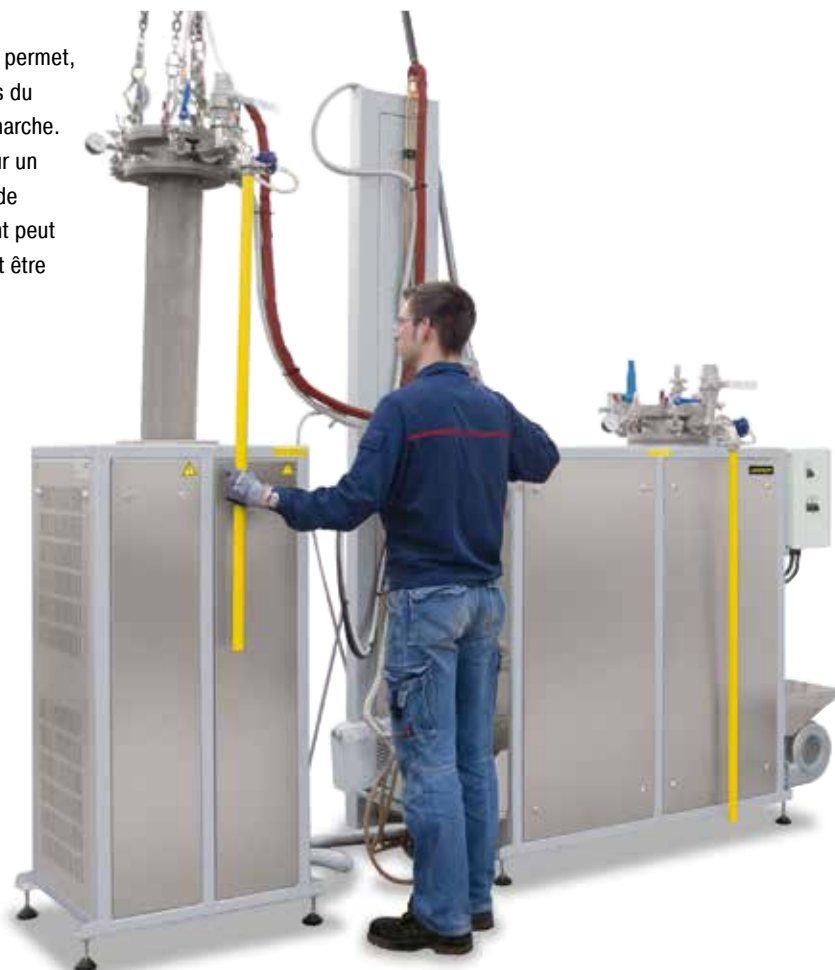
Four moufle étanche SR 170/1000/11 avec cornue remplaçable et station de refroidissement
