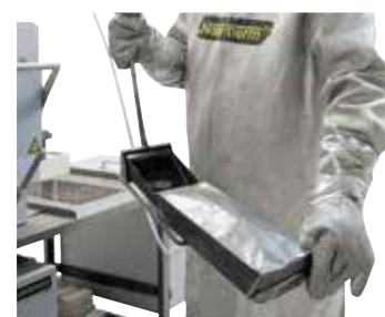
Utilisation de poches pour mise sous gaz
