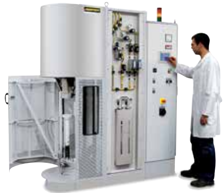
Four tubulaire RHTV 120/480/16 LBS avec, sur un côté, un tube de travail fermé, options gaz protecteur et vide ainsi qu'un entraînement à broche pour la sole élévatrice
