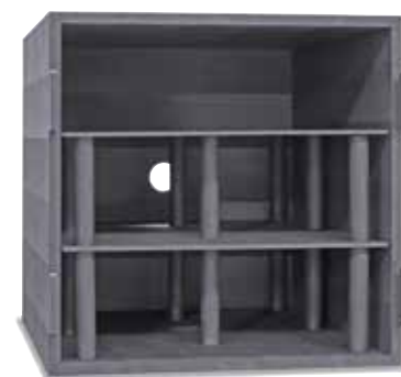
Chambre de chauffe en graphite avec porte-charge
