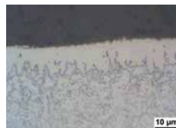
Détail d'une section métallographique d'un acier à outils pour travail à chaud et boruré dans la poudre
