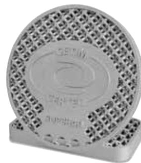
Pièces imprimées en aluminium, traitées à chaud dans le modèle N 250/85 HA (fabricant CETIM CERTEC sur plateforme SUPCHAD)
