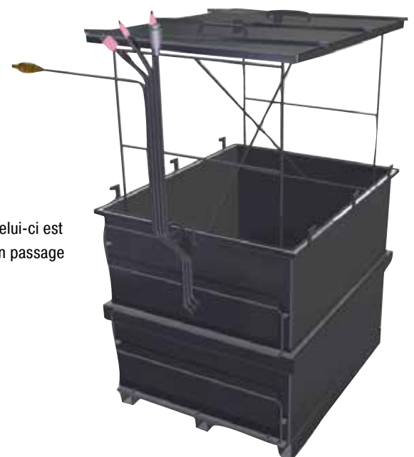
Bâti de mesure TUS pour le caisson de mise sous gaz protecteur
