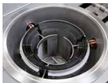
Moufle cylindrique avec système de chauffage au wolfram
