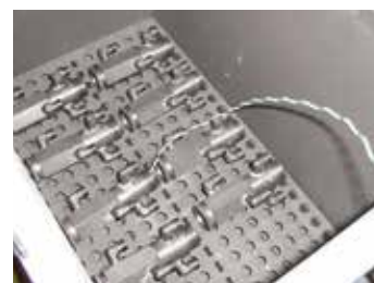
Soudobrasage dans caisson de mise sous gaz
