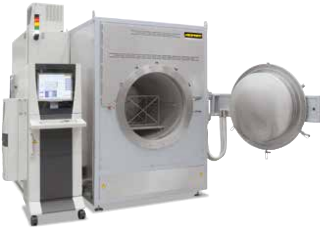
Four moufle étanche NR 300/08 pour le traitement sous vide poussé
