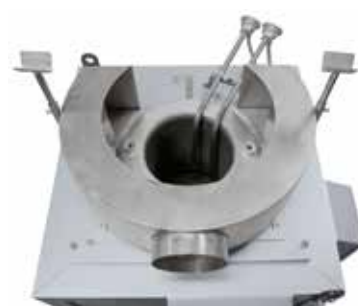
TS 30/18 avec deux thermocouples de bain de sel pour le traitement thermique de l'aluminium
