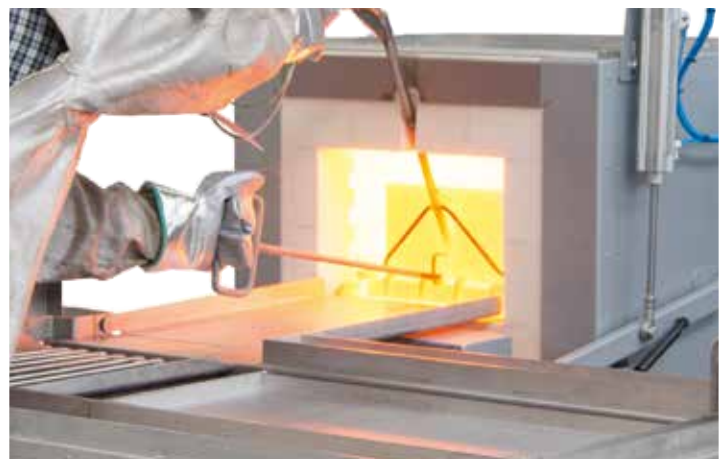
Système de trempe sous gaz protecteur avec four N 41/H
