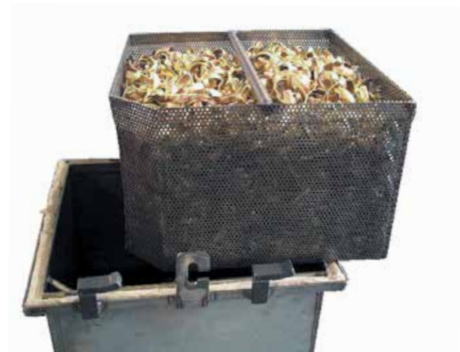
Recuit à blanc de pièces en vrac dans un caisson pour le recuit avec vide primaire
