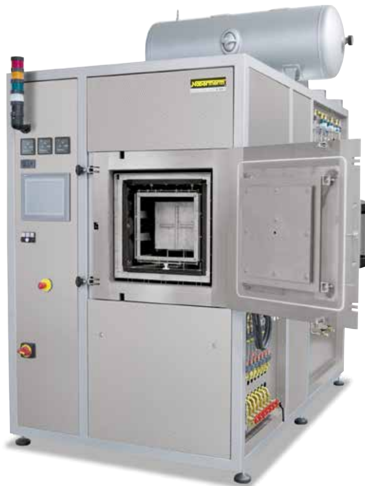
Four moufle étanche VHT 40/16-MO H 2 avec équipement pour hydrogène en version automatique
