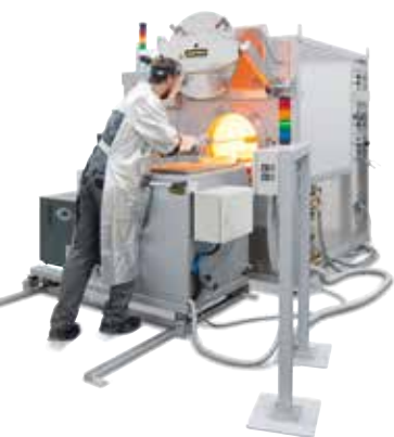
Installation de revenu semi-automatique avec four moufle NR 50/11 et bac de trempe à l'eau sur rails
