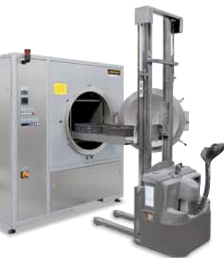
Chargement du four moufle étanche NRA 300/06 à l'aide d'un chariot élévateur
