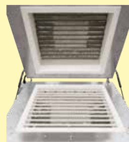
Éléments chauffants en sole et voûte réglable individuellement
