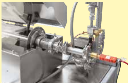
Raccord tournant étanche au gaz avec refroidisseur de gaz et thermocouple de charge
