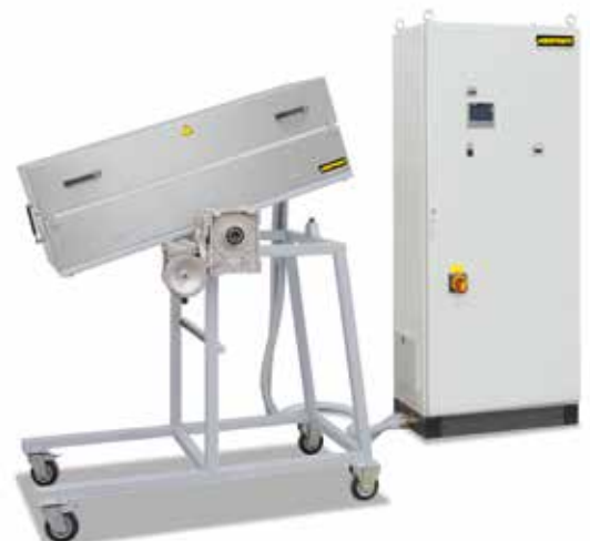
RS 120/1000/11S avec sole pour différents angles d'inclinaison
