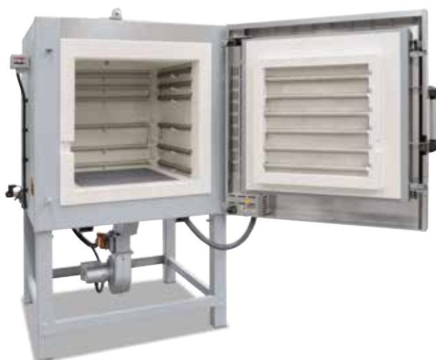
Four chambre LH 216/12 avec ventilateur d'air frais pour accélérer les temps de refroidissement
