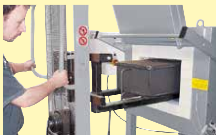
Travail avec caisson d'alimentation en gaz pour atmosphère gazeuse protectrice à l'aide d'une navette de chargement
