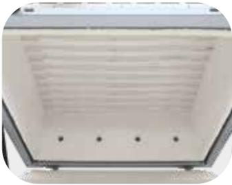
Éléments chauffants en disposition serrée dans la voûte, protégés par des tubes en verre de quartz, permettant un rayonnement direct et uniforme sur le verre
