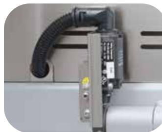
Coupure sécurisée du chauffage à l'ouverture de la cloche
