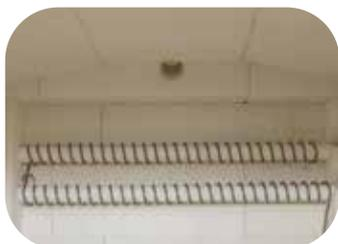
Voûte autoportante robuste, maçonnée selon le principe de la clef de voûte
