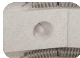
Thermocouple protégé, monté dans l'isolation
