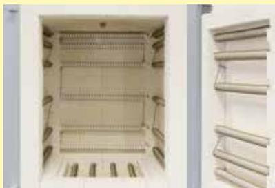
Chauffage sur cinq côtés et répartition spéciale des éléments chauffants pour une bonne répartition de la température
