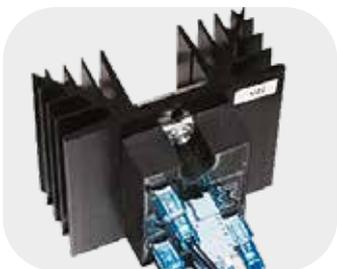
Commutation silencieuse du chauffage par relais semi-conducteurs
