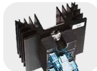
Commutation silencieuse du chauffage par relais à semi-conducteurs
