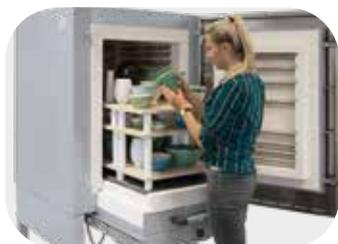
Hauteur de chargement ergonomique grâce au châssis support de 780 mm (four chambre N 440 - N 660 = 500 mm)
