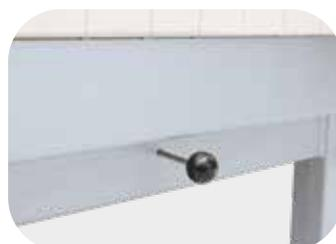
Trappe d'aération manuelle coulissante favorisant l'apport d'air au cours de la cuisson et temps de refroidissements courts pour fours chambre à partir de 440 litres faisant partie de la fourniture
