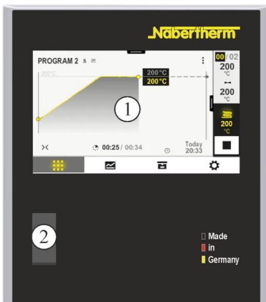
Fig. 10: Panneau de commande B500/C540/P570 (figure similaire)
