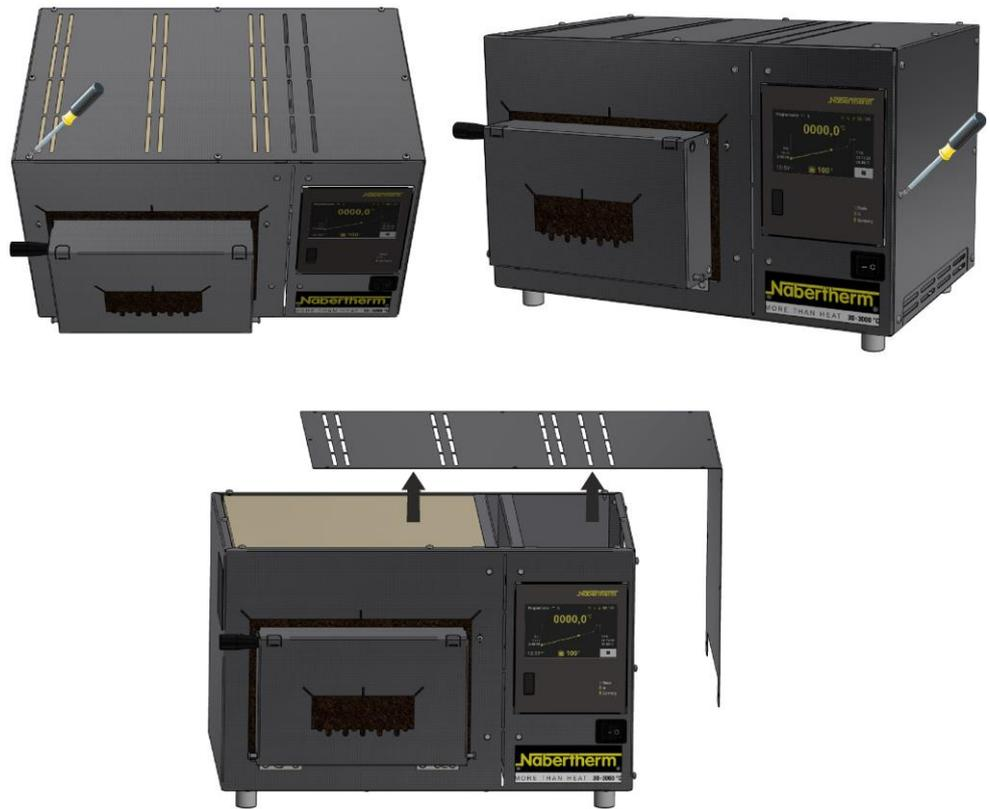
Fig. 22: Desserrer les vis de la carcasse et démonter le couvercle (figure similaire)
