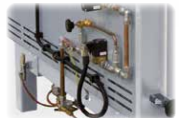
Système d'approvisionnement en gaz et thermocouple au four chambre
