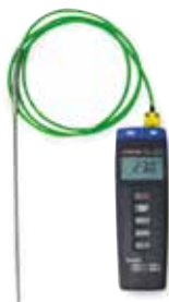
Indicateur de température pour four RAKU 100, thermocouple NiCr-Ni, affichage de 20 °C à 1200 °C, possibilité de brancher un second thermocouple avec affichage commutable
