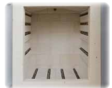
Chauffage sur trois côtés avec éléments chauffants protégés dans des rainures (N 140 E - N 280 E)
