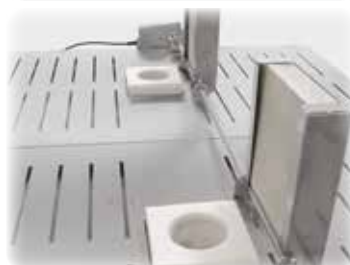
Trappe d'évacuation d'air motorisée pour un refroidissement accéléré du four après achèvement de la cuisson.
