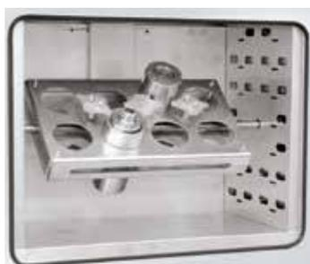
Dispositif rotatif électrique en option
